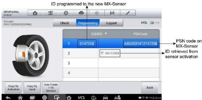
**Abbildung 4-34 Beispielbildschirm zur Programmierung nach OEM-Teilenr.**
